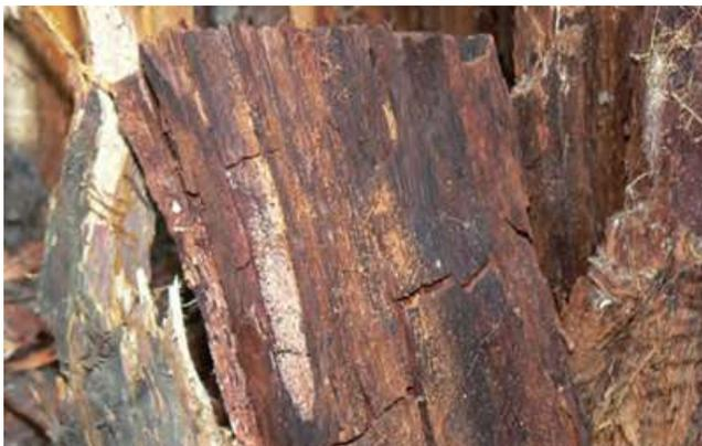
Figura 452: perdita di resistenza meccanica e funzionale del legno colonizzato
