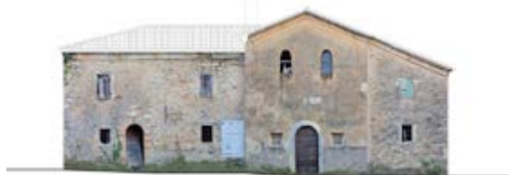
Prospetto ovest - Rilievo fotogrammetrico
